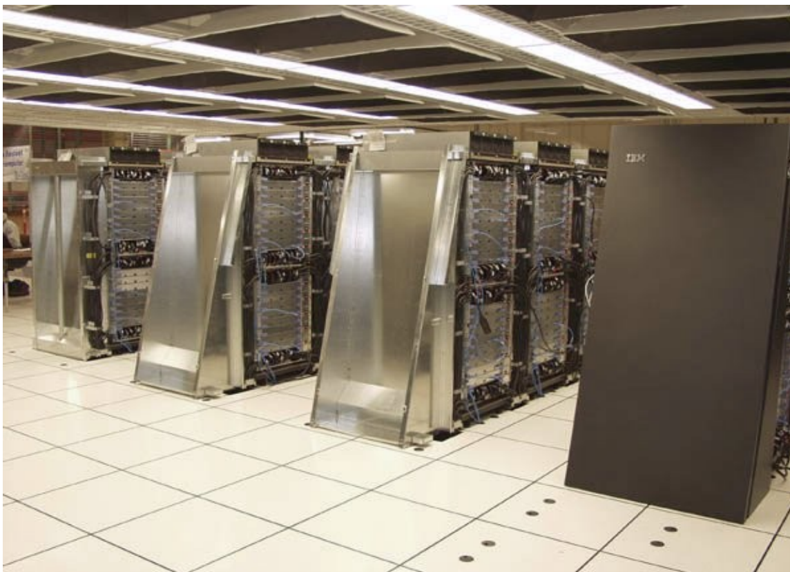
Blue gene (trocadilho pretendida) Supercomputador da IBM roda um Linux leve em cada nó de cluster de computadores e um completo Linux em seus nós de gestão.
