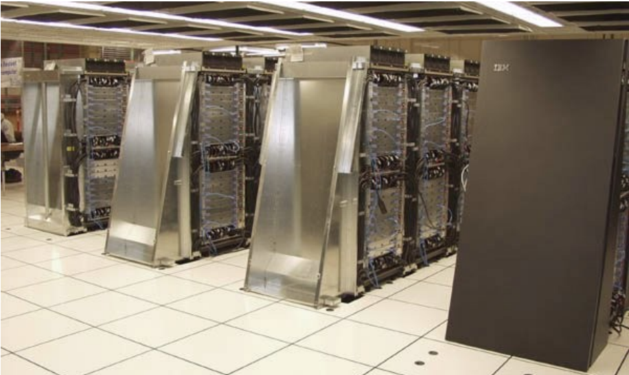
La super-computadora Blue Gene (basada en juego de palabras) de IBM corre un Linux ligero en cada uno de sus nodos, y un Linux completo en sus nodos de administración.
